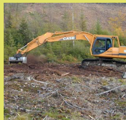
Gyrobroyeur à dents fixes porté par grue chenillée : Idéal pour les sols fragiles ou en pente
