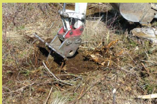
Potets travaillés et ameublissement localisé du sol : sous-soleur multifonctions et le scarificateur réversible
