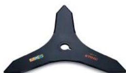
acier 3 dents, réversible broussailles denses, épineux
